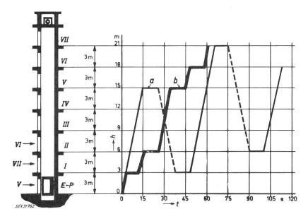
Bei Aufzügen mit Gruppensteuerung sind auf den Stockwerken für alle Aufzüge gemeinsame Druckknöpfe vorhanden. Die Impulse von den Stockwerkknöpfen werden einer Gruppen-Aussensteuerung zugeführt, die zusammen mit den individuellen Kabinen-Steuerungen jedes Aufzuges auf die Antriebsteuerung der Aufzüge wirkt.
