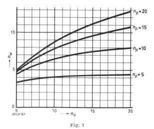
Mittlere wahrscheinliche Anzahl Aussteigehalte  $n_w$  in Funktion der Anzahl Aussteigestockwerke  $n_a$  und durchschnittlicher Personenzahl  $n_p$  in der Kabine
