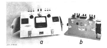
Fig. 14 Messbrücken «Telec» nach dem Schema der EdF
