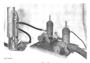
Fig. 13 Kalorimetrischer Entspanner mit Durchflussmesser
