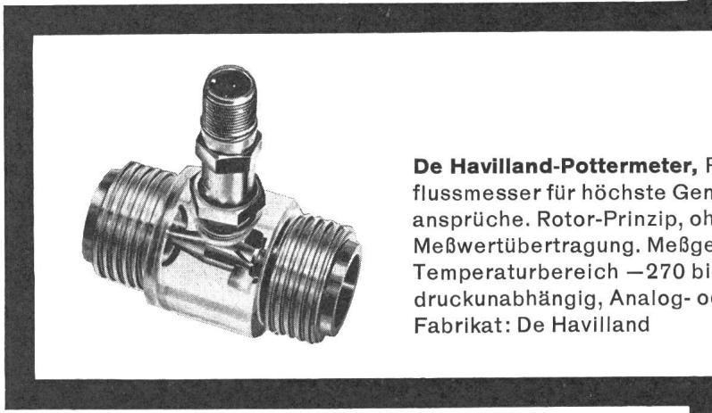
**De Havilland-Pottermeter**, Präzisions-Durchflussmesser für höchste Genauigkeitsansprüche. Rotor-Prinzip, ohne mechanische Meßwertübertragung. Meßgenauigkeit bis 0,1 % Temperaturbereich -270 bis +820 °C druckunabhängig, Analog- oder Digitalanzeige.
