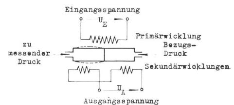
Differentialtransformatoren mit einem **ver** schiebbaren, zylindrischen Kern aus ferromagnetischem Material messen geradlinige Bewegungen. Die magnetische Kopplung zwischen der primären und den beiden se
