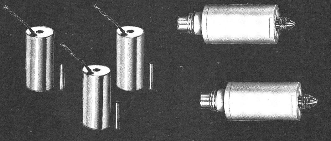
kundären Wicklungen und dadurch die Ausgangsspannung ist von der Lage des beweglichen Kernes abhängig.
