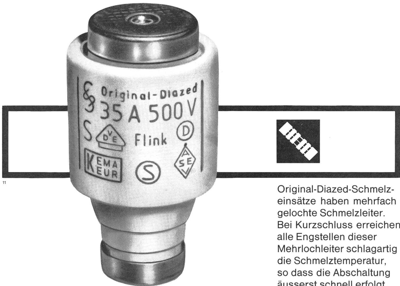
Original-Diazed-Schmelzeinsätze haben mehrfach gelochte Schmelzleiter. Bei Kurzschluss erreichen alle Engstellen dieser Mehrlochleiter schlagartig die Schmelztemperatur, so dass die Abschaltung äusserst schnell erfolgt.
