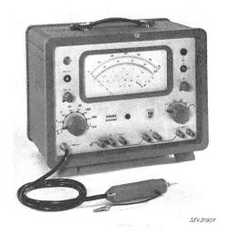
Fig. 1 Universal-Röhrenvoltmeter für professionelle Anwendungen
