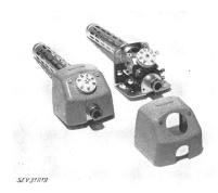
ist von aussen mittels einem Drehknopf und der Schaltabstand der beiden Umschalter beim Typ HBCC mittels einer Stellschraube nach Entfernen des Gehäusedeckels einstellbar. Das Fühlerschutzrohr und der mit einer Erdungsschraube versehene Gehäuseboden bestehen aus glanzverzinktem Stahlblech, das Mikroschaltergehäuse aus schwarzem Isolierpreßstoff und der Gehäusedeckel aus grauem Kunststoff.
