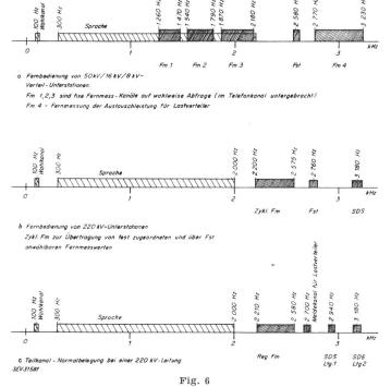
Typische Belegungen eines 4-kHz-Kanals mit Teilkanälen
