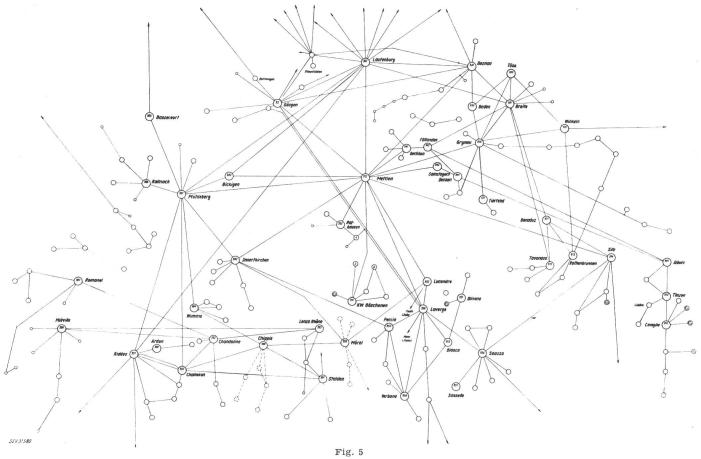
Prinzipieller Aufbau des Telephon-Netzes mit automatischer Durchwahl der schweizerischen Elektrizitätswerke Bestehende, offerierte und projektierte Anlagen
