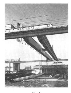
Fig. 1 Kran in Kastenbauart
