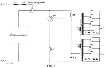
Tastenwahlsystem mit Tonfrequenz-Code «2 aus 6» Prinzipschaltung des Oszillators
