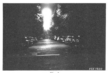
Fig. 5 **Beleuchtung einer Quartierstrasse**Leuchter mit je 2 Röhren 40 W, Warmton bestückt
