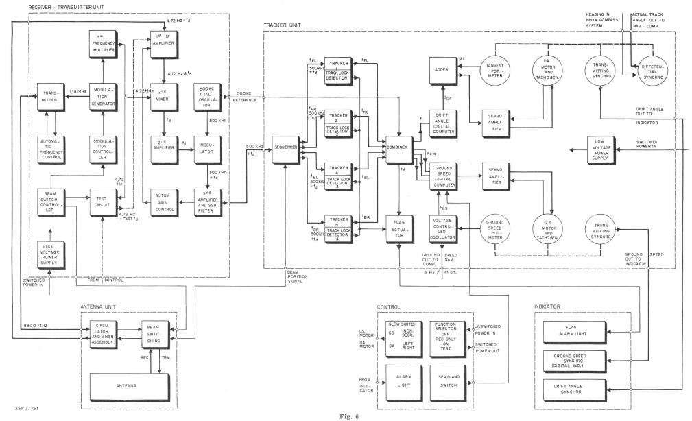
Blockschema der Doppler-Radar-Anlage
