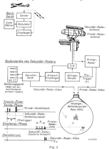
Prinzip-Schema des Sekundär-Radars wie es anfangs 1962 von der ICAO für weltweiten Einsatz genormt wurde. Die Installation dieser Geräte erfolgt mit Vorteil zusammen mit einem Primär-Radargerät
