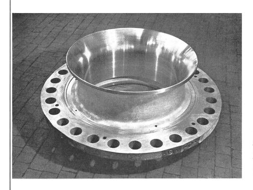
Venturidüse NW 700 mm zur Messung der Triebwassermenge vor der Turbine 0-4 m³/s, Betriebsdruck 85 atü, Probedruck 140 atü.
