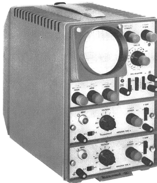
D-33 Zweistrahloszillograph mit zwei Einschubverstärkern, 3 div. Modelle 3 1/2"-Röhre mit 3,5 kV Nachbeschleunigung 60 ns Anstiegszeit
