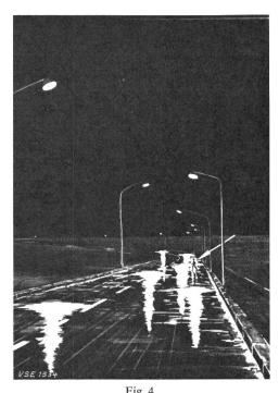
Reflexstreifen vor dem Fahrer; Leuchten über der Kurvenaussenseite montiert
