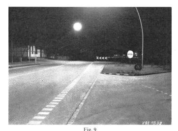
Die Signalisation eines gefährlichen Engpasses muss von einer Strassenlampe deutlich angestrahlt werden
