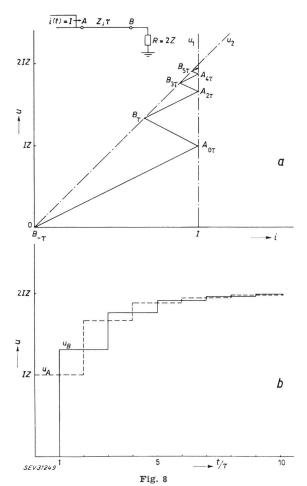
Eingeprägte Stromquelle: i(t)=I= konstant  $(R_4=\infty)$  a Bergeron-Diagramm; b Spannungsverlauf in A und B
