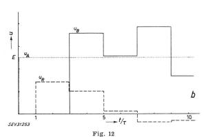
Widerstand im Zuge der Leitung a Bergeron-Diagramm; b Spannungsverlauf in A und B, sowie  $u_R$   $\overline{FX}_1 = \overline{FY}_1 + \overline{FP}$
