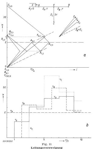
$\alpha$  Bergeron-Diagramm; b Spannungsverlauf in A, B, C und X
