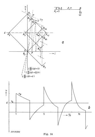
Leitungsabschluss mit einer Induktivität a Bergeron-Diagramm 4); b Spannungsverlauf in A und B  $\overline{FP}=1/2$   $\overline{OB}_1+1/2$   $\overline{FB}_{1.5}$
