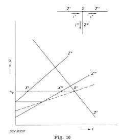
Zur Ermittlung der Spannung in einem Knotenpunkt einer Leitungsverzweigung
