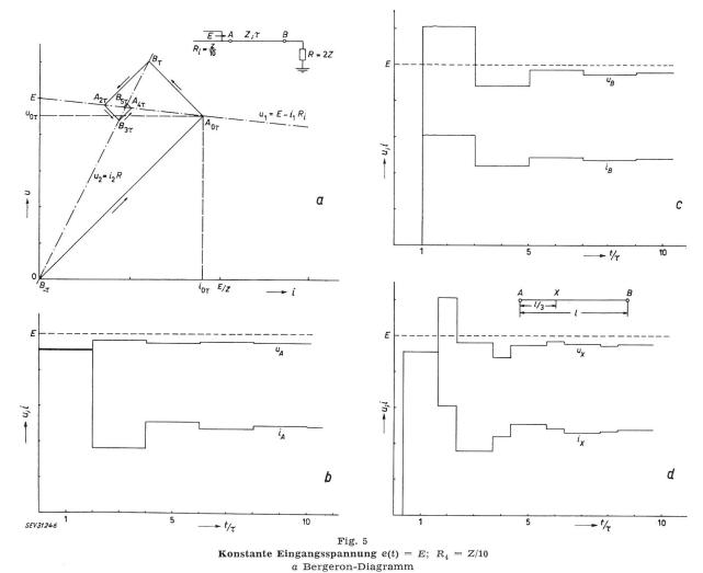
Spannungs- und Stromverlauf: b am Leitungsanfang A, c am Leitungsende B, d auf der Leitung in X
