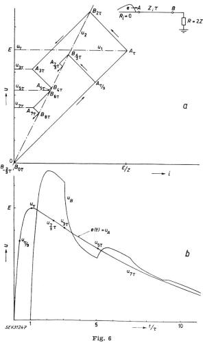
Zeitlich veränderte Eingangsspannung e(t);  $R_i = 0$ a Bergeron-Diagramm; b Spannungsverlauf in A und B
