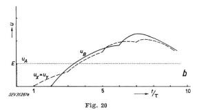
Kapazität quer zur Leitung a Bergeron-Diagramm; b Spannungsverlauf in A, X, Y und B  $\overline{FS}=1/2$   $\overline{Y_2X_2}+1/2$   $\overline{Y_3'X_3'}$
