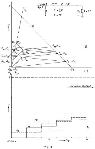
Leitungen mit unterschiedlichem Wellenwiderstand a Bergeron-Diagramm; b Spannungsverlauf in A, X und B
