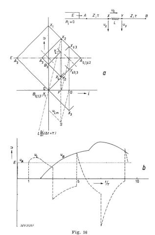
Induktivität im Zuge der Leitung a Bergeron-Diagramm; b Spannungsverlauf in A und B, sowie  $u_L$   $\overline{FP} = 1/2 \ \overline{X_3} \overline{Y_3} + 1/2 \ \overline{X_4} \overline{Y_4}$
