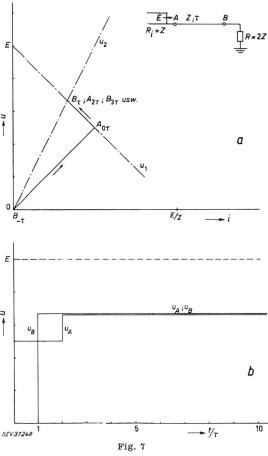
Konstante Eingangsspannung e(t) = E;  $R_i = Z$ a Bergeron-Diagramm; b Spannungsverlauf in A und B
