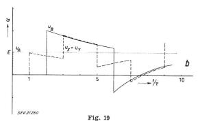
Induktivität quer zur Leitung a Bergeron-Diagramm; b Spannungsverlauf in A, X, Y und B
