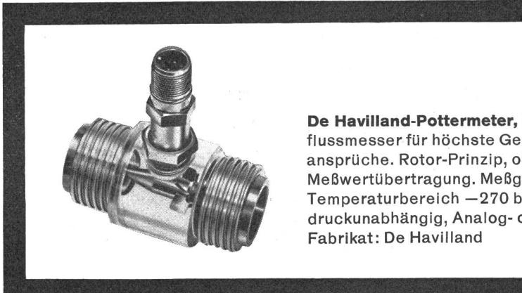
**De Havilland-Pottermeter**, Präzisions-Durchflussmesser für höchste Genauigkeitsansprüche. Rotor-Prinzip, ohne mechanische Meßwertübertragung. Meßgenauigkeit bis 0,1 % Temperaturbereich -270 bis +820 °C druckunabhängig, Analog- oder Digitalanzeige.
