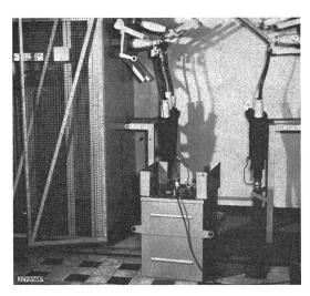
Fig. 3 Générateur autonome d'ondes de choc
