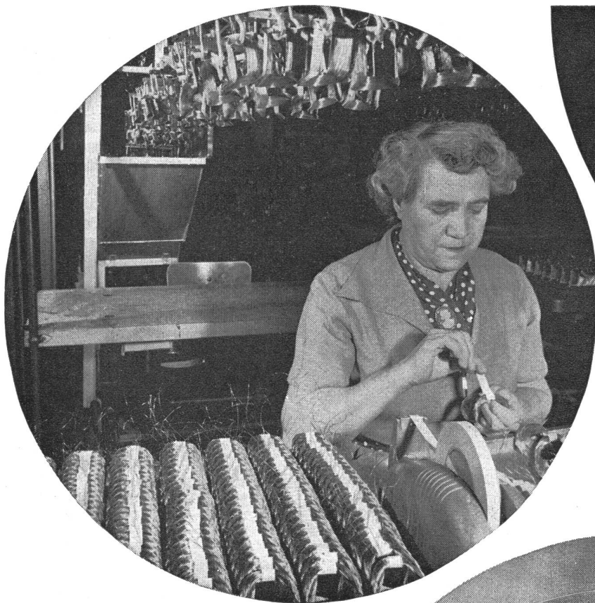
PERMACEL P-27 Papier- Elektroband, glatt, braun, Isolierung von Zuführungs- drähten, Befestigungen, Bündeln von Feldspulen.
