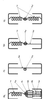
zielen. In Fig. 7 sind einige Möglichkeiten aufgezeigt. Bei der Ausführung a) besteht der Schmelzleiter aus zwei Spiralen, welche in der Mitte zusammengelötet sind. Die notwendige Trägheit wird dadurch erreicht, dass die die Trennstelle bildende Lötstelle mindestens zum Teil indirekt beheizt wird. Die hauptsächlichste Wärmeerzeugung erfolgt in den Spiralen. Die Aufheiz-
