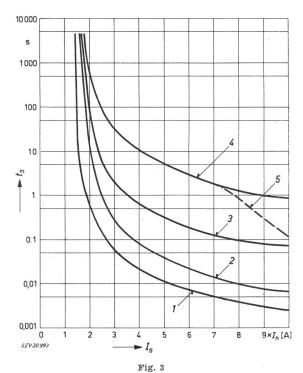
Mittlere Schmelzcharakteristik von Apparateschutz-Schmelzeinsätzen der Masse 5 (Durchmesser) imes 20 mm
