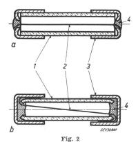
Schmelzeinsätze mit Aussen- bzw. Innenlötstellen a aussengelöteter Schmelzeinsatz, Stirnseite mit Lötzinn; b innengelöteter Schmelzeinsatz, Stirnseite metallisch sauber 1 Isolierrohr; 2 Schmelzleiter; 3 metallische Endkappen; 4 Lot
