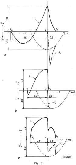
Abschaltoszillogramme von Schmelzeinsätzen 5 (Durchmesser) imes20 mm, ausgerüstet mit Feinsilber-Schmelzleitern von 0,1 mm Durchmesser
