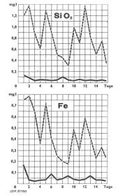
Schmutzrückstände für Säurephase löslich zu machen, ferner um das im Zunder vorhandene Magnetit in leichter lösliche Eisenoxyde umzuwandeln. Die eigentliche Beizphase erfolgt mittels inhibierter Säure, sie dient der Auflösung von Kieselsäure und der Metalloxyde (Zunder). Als Abschluss folgt eine Neutralisierung und Nachbehandlung. Zwischen den beschriebenen Phasen wird das zu beizende System gründlich durchge-
