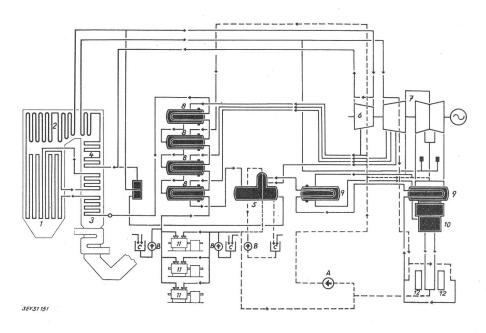
Fig. 2 Beizkreisläufe einer thermischen Anlage mit Zwangsdurchlaufkessel
