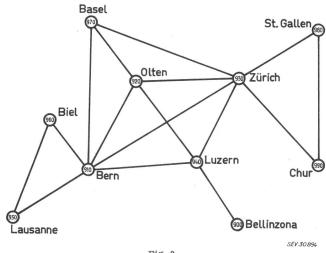
Fig. 2 Netzplan mit 10 Hauptämtern
