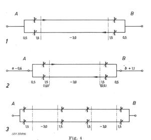
Regulierung der Restdämpfung im automatischen Telephonnetz 1 zwischen zwei Ortsteilnehmern von Hauptämtern; 2 zwischen Teilnehmern der Netzgruppe verschiedener Hauptämter; 3 zwei Trägerleitungen in einem Hauptamt direkt durchgeschaltet Werte in Neper
