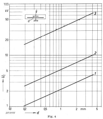
Ionisations-Einsatzspannungen  $U_4$  an Belagrändern (Widerstandsränder) von Kondensatordurchführungen
