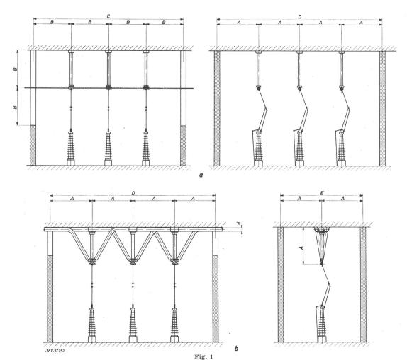
Raumeinsparung in elektrischen Anlagen bei Verwendung isolierter Sammelschienen für verschiedene Nennspannungen  $U_n$ a Schaltfeld mit blanken Schienen in atmosphärischer Luft
