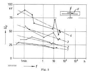
Durchschlagspannung  $U_d$  an den Rändern von Elementardurchführungen in Abhängigkeit von der Beanspruchungsdauer t
