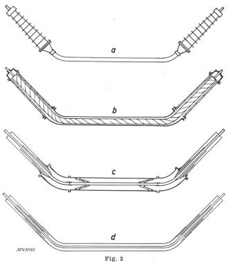
Verschiedene Möglichkeiten der Isolierung von Sammelschienen a Ölkabel mit Endverschlüssen; b Sammelschiene mit Ölpapier-Isolation. Starrer Behälter, bestehend aus Metallrohr mit beidseitigen Isolierbechern; c demontierbare Sammelschiene mit Gasisolation. Abstützungen des Leiters und Durchführungen aus Hartpapier; d Sammelschiene mit durchgehender Hartpapierisolation, Enden gesteuert.
