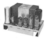
Stabilisiertes Netzgerät Typ 8630 200-250 V- 0-100 mA-
