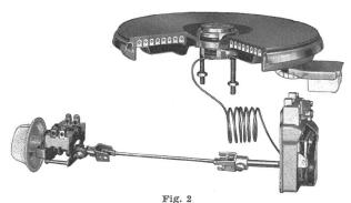
Schnittbild der automatischen Kochplatte, 18 cm Durchmesser, 2000 W, mit zugehörigem Thermoregler und Drehschalter
