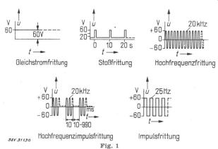
Zeitlicher Verlauf der Klemmenspannung u am Frittgenerator bei verschiedenen Frittarten
