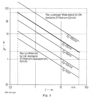
Kontaktwiderstände  $R_K$  in Abhängigkeit vom Frittgleichstrom I für Geräuschspannungen  $E_G$  von 1, 2,5, 10, 25 und 100 mV
