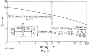
Abhängigkeit der Unsymmetriedämpfung  $a_2$  von der Differenz  $(W_1-W_2)$  der Längswiderstände in einer Sprechverbindung
