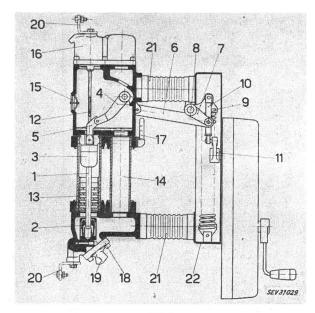
Fig. 6 Ölstrahlschalter in Stützerbauweise
