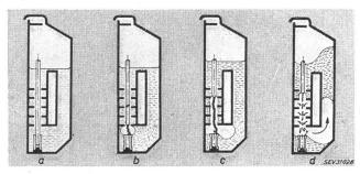
Fig. 5 Phasen des Löschvorganges bei Axialblasung Bezeichnungen siehe im Text
