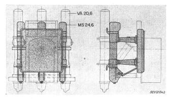
Fig. 4 Grössenvergleich ölarmer Schalter Baujahre 1947...1961
