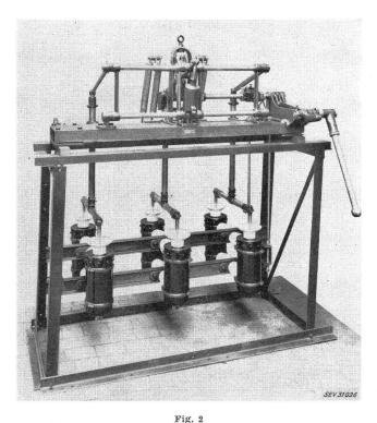
Ausführung eines Topfschalters, Typ ZO 20 Nennspannung 20 kV; Nennstrom 300 A; Ausschaltleistung 60 MVA
