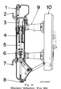
1 Schalterhaube; 2 oberer Anschluss; 3 fester Kontakt; 4 Löschkammer; 5 Schaltstift; 6 Rollenkontakt; 7 unterer Kontakt; 8 Ölablaßschraube; 9 Stützer; 10 Federantrieb
