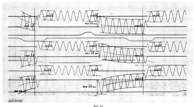
Oszillogramm einer Schnellwiedereinschaltung mit dem ölarmen Schalter Typ MS 24.6
