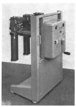
Fig. 19 Ölstrahlschalter Typ HP 206c mit Schalterwagen
