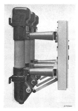
Fig. 18 Ölarmer Schalter Typ MS 24.6 mit Federantrieb Nennspannung 24 kV; Nennstrom 630 A; Nennausschaltleistung 400 MVA; Ausschaltzeit 0,07 s  $\pm$  10 %
