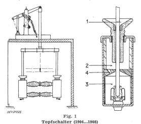
1 Stellung «Aus» des Schalters; 2 Pufferkammer mit Luftpolster; 3 Druckkammer (ölgefüllt); 4 Öffnung zur Druckbegrenzung
