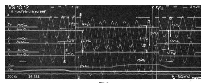
Oszillogramm einer Ein-Aus-Schaltung mit ölarmem Schalter, Typ VS 10.12
