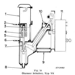
1 Gasabzug; 2 oberer Anschluss; 3 fester Kontakt; 4 Löschkammer; 5 Schaltstift; 6 unterer Anschluss; 7 Rollenkontakt; 8 Ölablaßschraube; 9 Stützisolator; 10 Öleinfüllschraube; 11 Federantrieb
