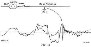
Wie Fig. 18, aber Spannungen beidseitig des Schalters im gleichen Maßstab über derselben Nullinie gezeichnet
