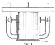
Schalterkonstruktion aus dem Jahre 1900 mit axialer Lichtbogenbeblasung und konzentrischer Luftströmung
