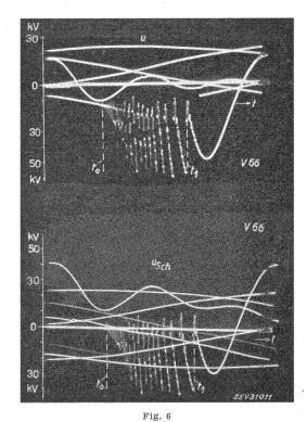
Ausschaltüberspannung an Transformator 16 kV, 16 % Hz, Druckluftschalter nach Fig. 5
