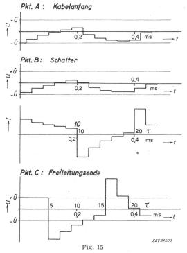
Aus dem Bergeron-Diagramm (Fig. 14) entnommener Spannungsund Stromverlauf der Punkte A, B und C über der Zeit t in ms oder als Vielfache von  $\tau$
