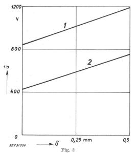
Ausschaltüberspannung  $\hat{u}$  an zwei Mustern kleiner Transformatorkerne in Funktion des Luftspaltes  $\delta$ 1 Dynamoblech; 2 korngerichtetes Blech
