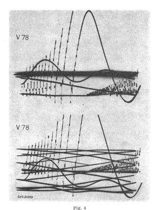
Ausschaltüberspannung an Transformator 16 kV, 16 % Hz, mit Druckluftschalter
