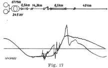
Wie Fig. 17, aber Spannungen beidseitig des Schalters im gleichen Maßstab über derselben Nullinie gezeichnet
