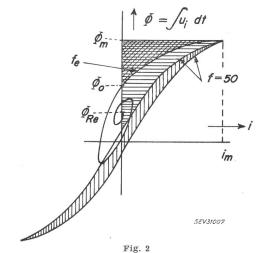
Stationärer und eigenfrequenter Flussverlauf in einem Transformator
