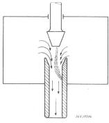
Fig. 2 Löschkammer-Konstruktion aus dem Jahre 1923 mit der Unterbrechungsstelle im Druckluftbehälter
