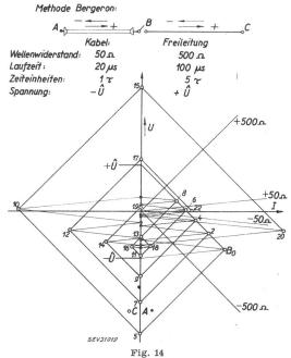
Beispiel eines Bergeron-Diagramms für das Schliessen des Schalters in B bei beidseitigen Spannungen +  $\mathcal V$  und -  $\mathcal V$
