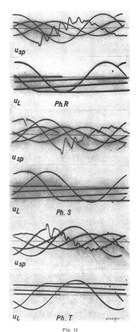
Leerschalten einer 220-kV-Leitung mit 2  $\times$  6,5 km Kabel Ph.R, Ph.S, Ph.T Phasen R, S, T;  $u_{sp}$  Spannung speiseseitig;  $u_L$  Spannung leitungsseitig
