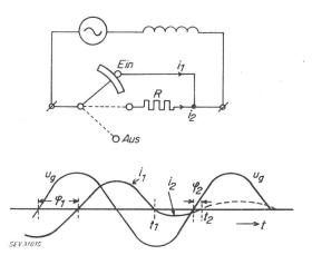
Fig. 10 Schema des Schalters mit Schalterwiderstand R
