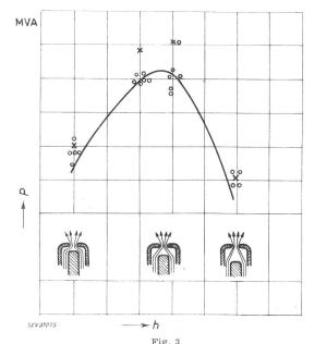
Abhängigkeit der Ausschaltleistung von der Unterbrechungsdistanz eines Druckluftschalter-Leistungskontaktes P Ausschaltleistung; h Hub
