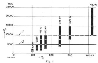
Genormte Nenn-Ausschaltleistungen P. in Funktion der höchsten spezifizierten Nenn-Spannung  $U_n$  nach Publ. 56-3 der CEI
