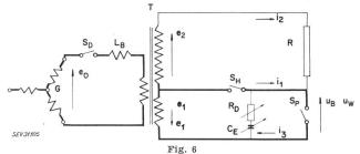
Schematisches Schaltbild der synthetischen Prüfschaltung nach Skeats Bezeichnungen siehe im Text
