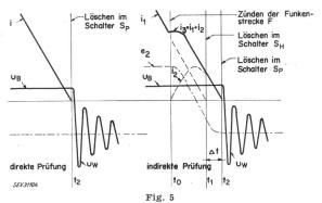
Zeitlicher Verlauf von Strom und Spannung bei der synthetischen Prüfung mit der Weil-Schaltung in der Gegend des Stromnulldurchganges
