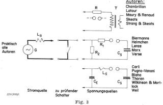
Schematisierte Beispiele der Strom- und Spannungsquellen für synthetische Prüfschaltungen
