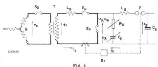
Schematisches Schaltbild der synthetischen Prüfschaltung
