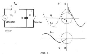
Ausschaltleistung, Kurzschlussleistung des Generators und Ausschaltvorgang im einphasigen Kreis
