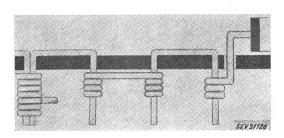
Querschnitt durch eine Montageplatte mit Klammerverdrahtung
