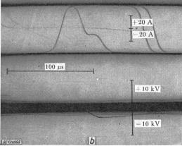
Fig. 2 Spannungsverlauf bei thermischen Wiederzündungen a Klemmenkurzschluss (14,7 kA, 15,5 kV, 0,55 kV/ $\mu$ s); b Abstandskurzschluss 200 m (9,1 kA, 6,3 kV, 0,38 kV/ $\mu$ s)
