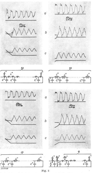
Verlauf der wiederkehrenden Spannung bei künstlichen Leitungen mit je 10 Gliedern verschiedener Art (Kleinmodell)
