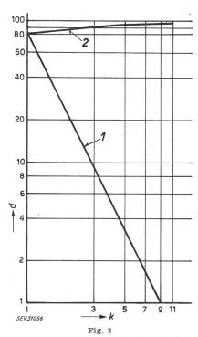
Harmonische Analyse einer Dreieckschwingung 1 Anteil der k-ten Oberschwingung; 2 Anteil aller Oberschwingungen 1...k
