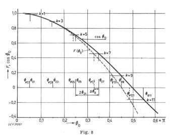
Bestimmung der Frequenzfehler der Oberschwingungen einer Leitung mit Zusatzkondensatoren
