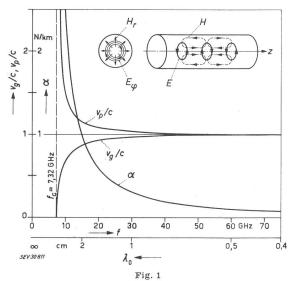
Feldbild der  $H_{01}$ -Welle. Relative Phasengeschwindigkeit  $v_p/c$ , relative Gruppengeschwindigkeit  $v_g/c$  und Dämpfungskonstante  $\alpha$  der  $H_{01}$ -Welle in einem Kupferhohlleiter ( $\kappa=57\cdot10^4$  S/cm) mit einem Innendurchmesser von 5 cm in Abhängigkeit von der Frequenz f bzw. von der Wellenlänge  $\lambda_0$
