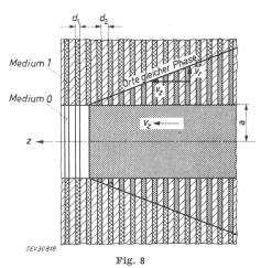
Die Entstehung der radialen Wellen bei einer in Richtung z laufenden Welle (schematisch)
