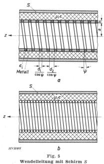
a Wendelleitung aus einem Wendeldraht mit rechteckigem Querschnitt; b Wendelleitung aus einem Wendeldraht mit rundem Querschnitt; \( \psi\$ Steigungswinkel der Wendel \)
