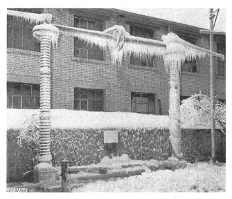
Fig. 8 Vereisungsversuch an einem 2-Säulen-Trenner 420 kV
