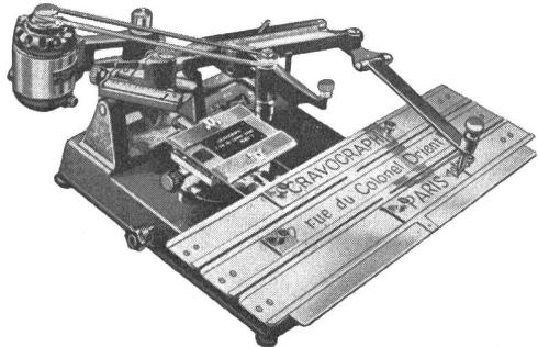
\* GRAVOGRAPH ist der ideale Gravierapparat für das Elektrizitätswerk, das Installationsunternehmen und die städtischen Betriebe.
