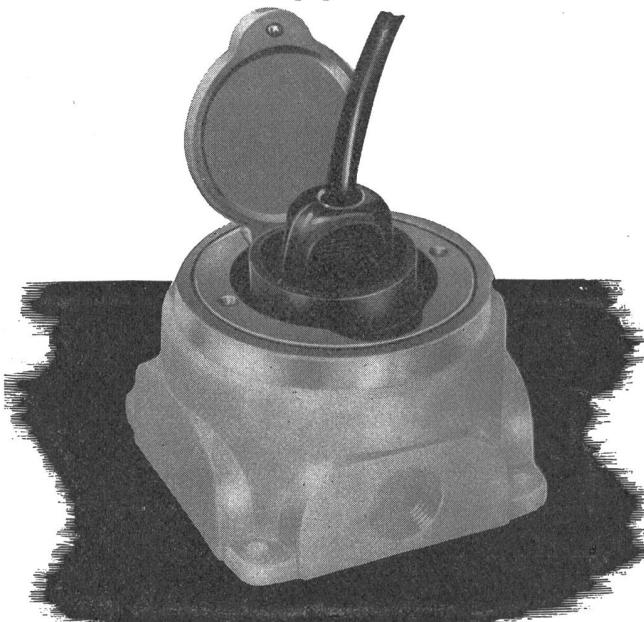
Beim Öffnen des Klappdeckels steigt eine Gummimanschette selbsttätig über das Bodenniveau empor und verhindert das Eindringen von Putzwasser und Schmutz
