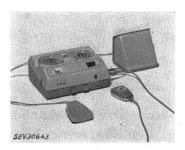
und Röhrenheizspannung. Apparat für verschiedene Spannungen umschaltbar. Antrieb des Tonbandes durch Spaltpolmotor. Schutz vor Überlastung durch zwei Kleinsicherungen im Netzstromkreis. Grundplatte aus Metall, Gehäuse aus Isolierpreßstoff. Zuleitung Doppelschlauchschnur mit Stecker 2  $P+E_r$  fest angeschlossen. Der Diktierapparat entspricht den «Vorschriften für Apparate der Fernmeldetechnik» (Publ. Nr. 172).
