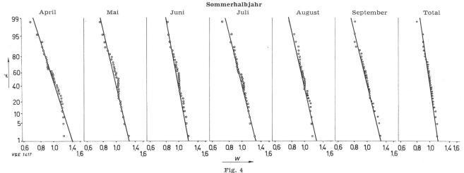
Koeffizienten der Erzeugungsmöglichkeit der Wasserkraftwerke
