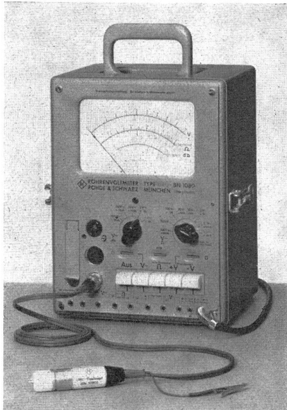
Röhrenvoltmeter Type URU 10 Hz - 1000 MHz, mit Tastkopf
