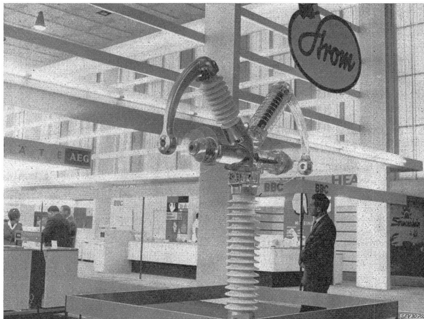
Fig. 2 Doppelschaltkopf für Hochspannungsnetze bis 500 kV
