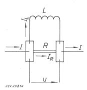
springt von  $+I_K$  auf  $-I_K$ . Da hiebei die kritische Stromstärke nie überschritten wird, kann kein Spannungsabfall U auftreten, so dass der Strom  $I_L = +I_K$  unverändert weiter fliesst. Die Information des Schreibimpulses ist nunmehr Kreisstrom  $I_L = I_R = I_K$ als gespeichert.
