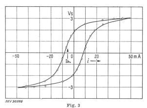
Vollständige magnetische Kennlinie der Steuerwicklung eines Magnetverstärkers
