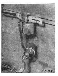
Die bereits gut eingerichtete Materialprüfanstalt des SEV ist kürzlich durch eine Niederspannungs-Hochleistungsanlage ergänzt worden. Diese Anlage vermag Ströme von etwa 100 kA während 1 s bei einer Spannung von 550 V abzugeben. Sie soll vor allem für die Prüfung von Niederspannungsmaterial, aber auch von
