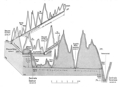
Fig. 2 Längenprofil der Kraftwerke Vorderrhein
