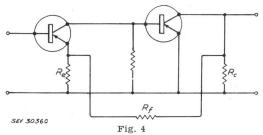
Gegenkopplung über zwei Stufen  $R_c$  Kollektorwiderstand;  $R_c$  Emitterwiderstand;  $R_f$  Gegenkopplungswiderstand
