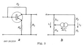
Gegengekoppelte Emitterstufe als Brückenschaltung zur Erzeugung einer von  $\alpha'$  unabhängigen Eingangsimpedanz
