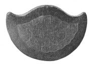
Fig. 2 Schnitt durch einen «Peka»-Kabelschuh von 120 mm² verpresst mit der «Peka»-Blitzpresse
