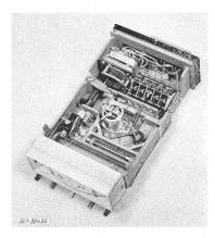
Fig. 15 Chassis eines Druckbügelreglers
