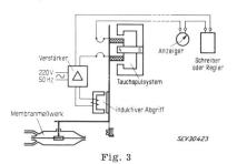
Schema eines Messumformers für den einem Durchfluss entsprechenden Wirkdruck
