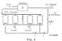
Schema eines pneumatischen Reglers für das Einheitsregelsystem
