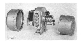
${\bf Fig.~4}$  Messumformer für hohe Drücke mit magnetischem Abgriff
