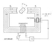
Fig. 5 Magnetischer Abgriff, schematisch
