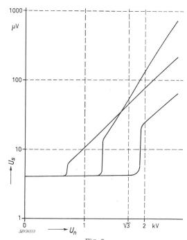
Fig. 3 Radio-Störspannung  $U_s$  in  $\mu V$  als Vielfaches der Nennspannung  $U_n$  eines 72,5-kV-Giessharz-Spannungswandlers
