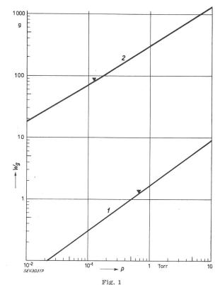
Wassergehalt  $W_g$  von Papier und Öl eines 300-kV-Stromwandlers in Funktion des Dampfdruckes p Temperaturen: von Papier 80 °C, von Öl 30 °C;
