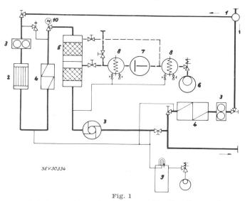
Vereinfachtes Schema der fahrbaren Ölaufbereitungsanlage Durchsatz im Aufbereitungskreis stufenlos regelbar von 0...7000 l/h 1 Grobfilter; 2 Feinfilter; 3 Förderpumpe; 4 Durchlauferhitzer; 5 zweistufige Entgasungskolonne; 6 Vorpumpe; 7 Millitorrpumpe; 8 Kondensator; 9 Restgasgehaltmessgerät; 10 Motorventil
