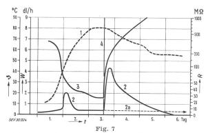
Diagramm der Vakuumtrocknung eines umgebauten Transformators am Aufstellungsort
