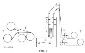
Schéma d'une machine à préimprégner le papier 1 Double dérouleur; 2 Rouleaux de chauffage; 3 Cuve à vide; 4 Cuve d'imprégnation; 5 Couteaux racleur; 6 Rouleaux de tirage; 7 Double enrouleur
