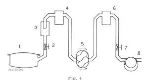
Schéma d'une installation d'imprégnation de câbles à masse 1 Cuve d'imprégnation; 2 Vanne; 3 Retenue de masse; 4 Condenseur; 5 Pompe millitorr de 8000 m³/h à 10-1 mm Hg; 6 Condenseur; 7 Vanne automatique; 8 Pompe à palette de 300 m³/h à 1 mm Hg
