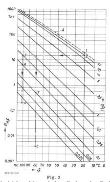
Feuchtigkeitsgleichgewicht zwischen Papier oder Preßspan und umgebender Luft in Funktion der Temperatur  $\theta$ Parameter: Papierfeuchtigkeit in Prozent des Trockengewichtes
