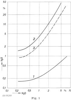
Verlustfaktor tg  $\delta$  von Isolierpapier bei 50 Hz in Funktion des Wassergehaltes in Prozent des Trockengewichtes % H<sub>2</sub>O Kurve 1 bei 20 °C; 2 bei 110 °C; 3 bei 90 °C (interpoliert)
