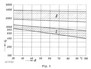
Kippspannung  $U_k$  beidseitig gekühlter Isolierzylinder aus ölimprägniertem Papier in Funktion der Temperatur  $\vartheta$  I mit Heissluft getrocknet; II im Hochvakuum getrocknet
