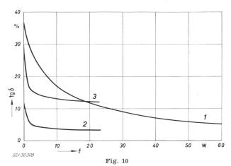
Verbesserung des Verlustfaktors tg  $\delta$  der Papierisolation von Transformatoren nach der Ölerneuerung gemessen bei einer Öltemperatur von  $\vartheta=60~^{\circ}\mathrm{C}$
