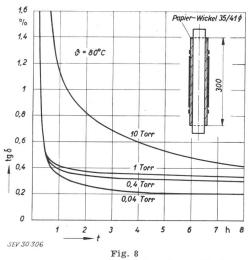
Vakuum-Trocknung von Modellwickeln bei verschiedenen Drücken θ Temperatur Weitere Bezeichnungen siehe Fig. 7
