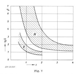
Vergleich der Trocknung von je 13 Transformatoren gleichen Typs H Heissluft-Trocknung im eigenen Kasten; V Hochvakuum-Trocknung mit 0,2 Torr im Ofen;  $\operatorname{tg}\delta$  Verlustfaktor; t Zeit
