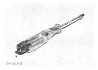
Glimmlämpchen und einem in Serie geschalteten Schutzwiderstand von 1 Megohm. Kontaktbüchse hinten am Handgriff. Isoliert befestigter Clips.
