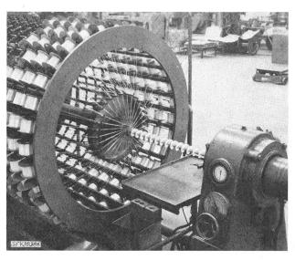
Fabrikation der Bandwendelisolation eines Antennenspeisekabels
