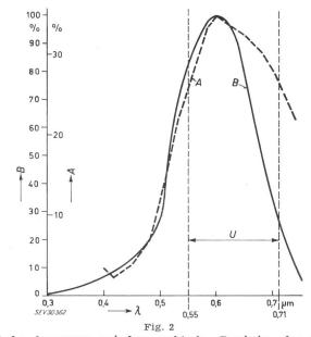
Optische Anpassung zwischen spektraler Remission der Codezeichen und Empfindlichkeitsspektrum der Photoelemente A Remissionsdifferenz zwischen Gelb/Violett; B Spektrale Empfindlichkeitskurve für Cadmiumsulfid-Photowiderstände; \(\lambda\) Wellenlänge; Bereich U: Gebiet der maximalen Remissionsdifferenz
