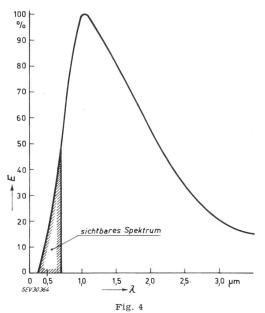
Spektrale Emissionsverteilung einer 25-W-Glühlampe (Farbtemperatur 2500  $^{\circ}$ K)
