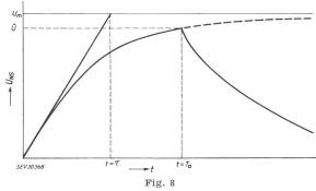
Idealisiertes Nutzsignal am abtastenden Photowiderstand
