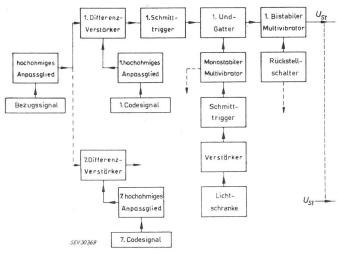
Fig. 9 Blockschema der Abtastapparatur  $U_{St}$  Steuersignal
