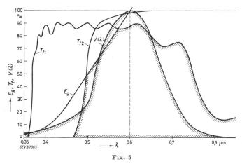
Relative Glühlampenemission und Filtertransmission im Vergleich zur spektralen Empfindlichkeitskurve des Photowiderstandes
