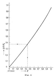
Modulations faktor  $\Delta R/R_v$  in Funktion der Druckdichte  $\delta$
