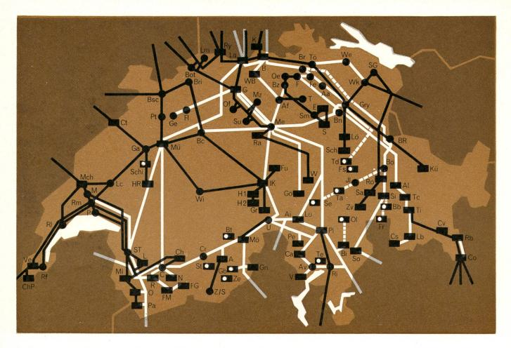
Fig. 7 Die Hauptübertragungsleitungen des Hochspannungsnetzes, Stand Anfang 1961
