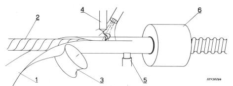
Fig. 3 Schematische Anfertigung des Wellmantels
